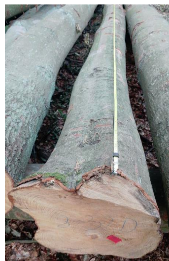
Ryc. 9. Pomiar długości sztuki drewna z pominięciem rzażu podcinającego
